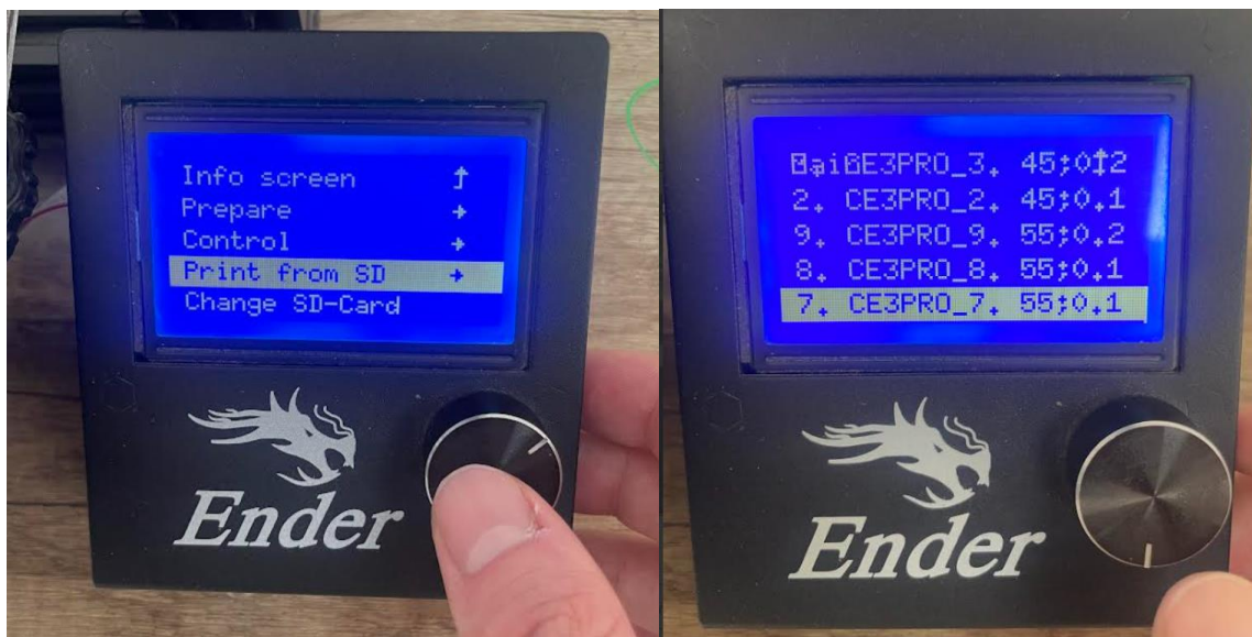
Fig.4.9. Hapat per ngarkimin e programit në softuerin e Printerit
